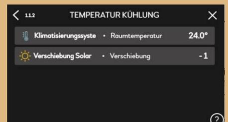
NIBE Wärmepumpenanlagen, welche die PV-Smart-Funktion in Verbindung mit einem im Sommer aktiven Kühlbetrieb nutzen können, beziehen einen Großteil der zum Kühlbetrieb erforderlichen Elektroenergie aus Überschüssen der PV-Anlage. Somit können die Vorteile eines komfortablen Kühlbetriebs ohne signifikant erhöhte Betriebskosten genutzt werden.
