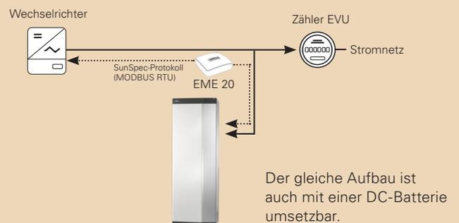
Der gleiche Aufbau ist auch mit einer DC-Batterie umsetzbar.
